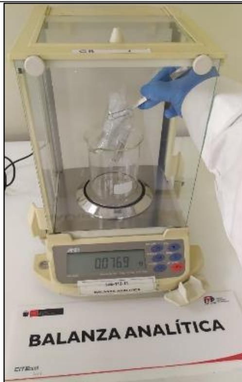
**Figura N° 12.** Pesado de las piezas de película plástica (micas)
