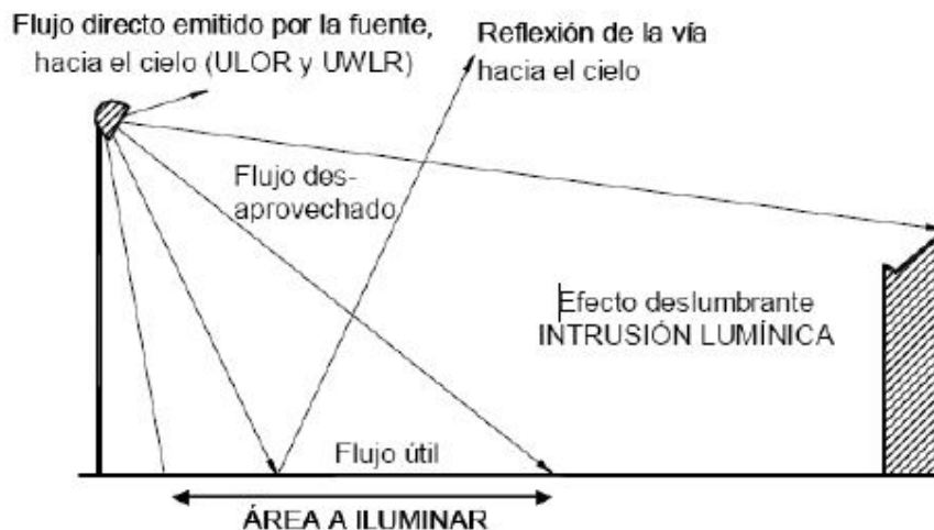
FIGURA 26. Parámetros de cálculo de la contaminación lumínica
